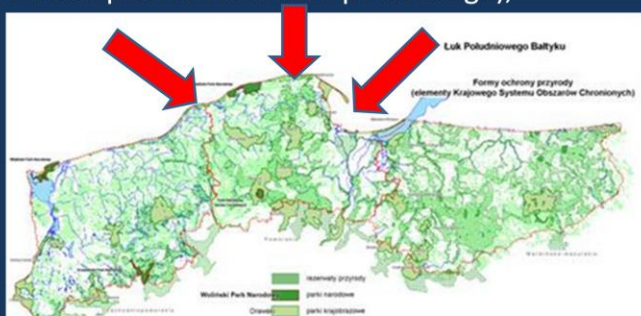
Rys. 14. Kierunki wiatru sprzyjające wezbraniom sztormowym na południowym wybrzeżu Bałtyku
